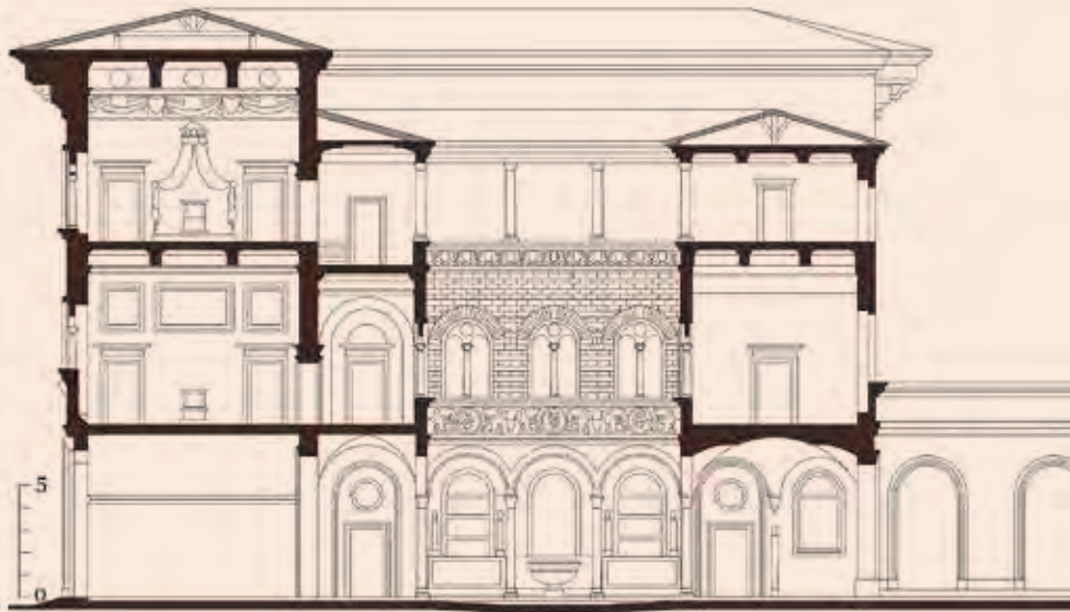
Схема разреза палаццо Медичи-Риккарди Чертеж автора, 2014
